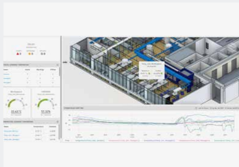
Visualização do gêmeo digital com monitoramento em tempo real e mapeamento de dados ambientais e ocupação
